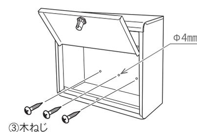
下部のねじ穴に残りの3本の③木ねじで①ポストを固定してください。最後に②で仮止めした③木ねじをしっかりと固定してください。ポスト用ポール使用時背面の穴は雨水浸入防止の為、④シールでふさいでください。
