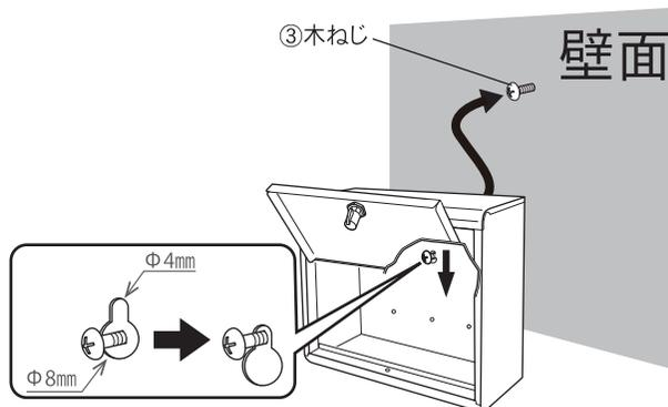
③木ねじを壁面に仮止めし、①ポスト上部の穴をかけてください。
