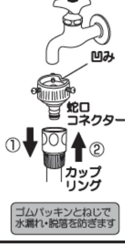
① (1) 蛇口コネクターについているカップリングを①↓の方向に下げる、部品を2つに分けてください。(蛇口コネクター、カップリング)
