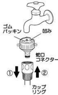
ゴムパッキンでねじで水漏れ・蛇口破損を防止します。
