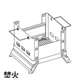
組付け板 2 枚を側板下段に 取付けます。
