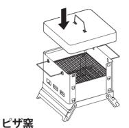
組付け板を1枚は側板上段に、 1枚は側板下段に取付け、
