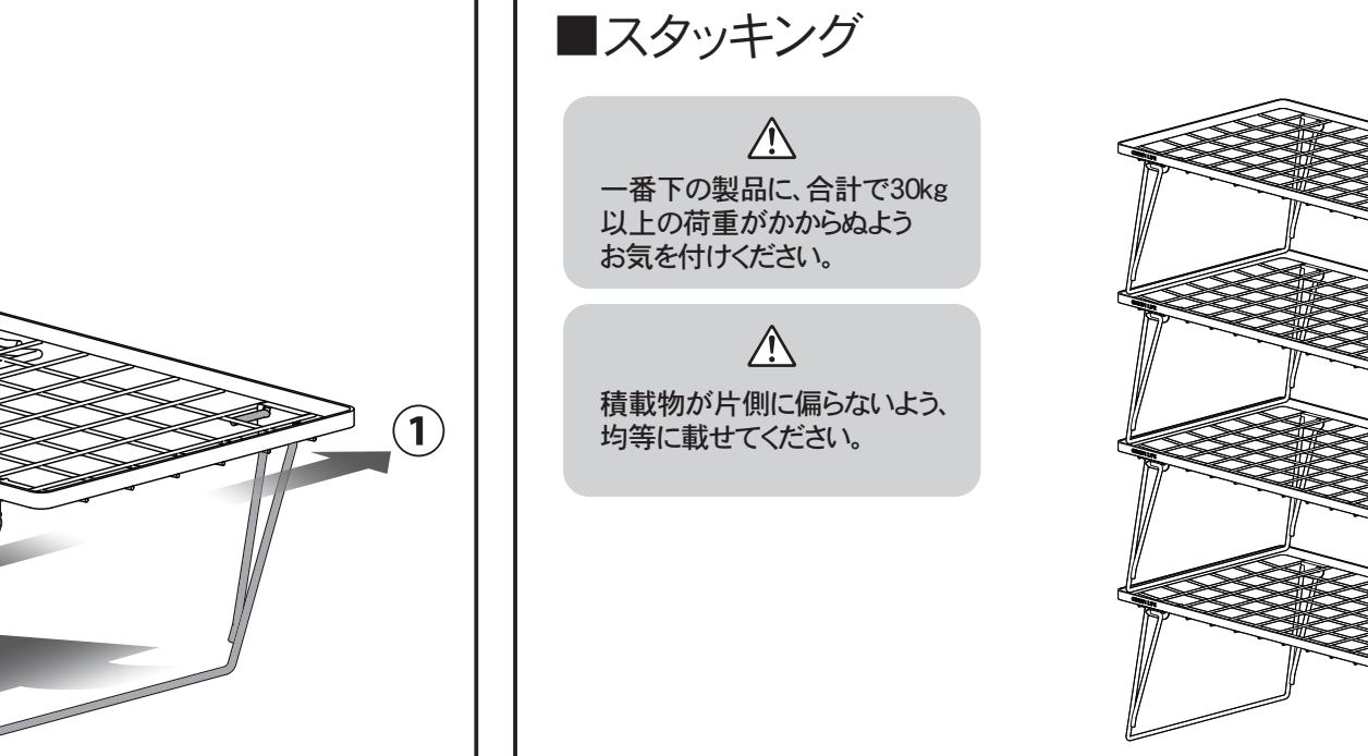
(1) 矢印①の方向に脚を広げ、突起部から脚を外して折りたたみます。
