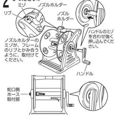
ノズルホルダーのミゾが、フレームのリブとかみ合うように、取付けてください。
