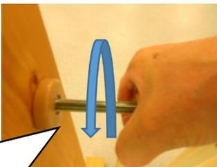
下部のアジャスターが「ハの字」になったり、「逆ハの字」になった状態になりますと、ストッパーがストッパー受けに落ちずにドアが固定されない状態になります。全てのアジャスターが水平になるよう調整し、ストッパーが正常に収まるようにしてください。
