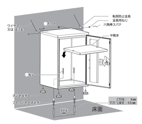
中敷きを外し、 本体 に アジャスター をつけます。(4箇所) 取付けピッチに従い、設置場所(床面)へ電動工具で下穴をあけて ください。(2箇所)
