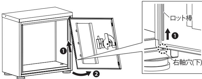
① ロット棒を上引き上げ、右軸穴(下)から抜き
