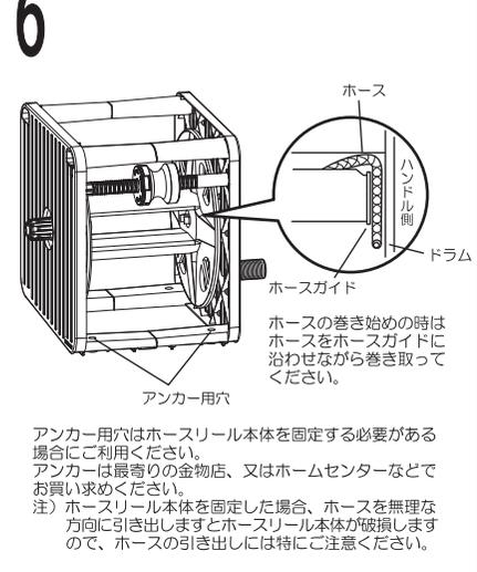
冬期は凍結による破損防止の為 使用後はホース及びノズル内の水を抜いてください。
