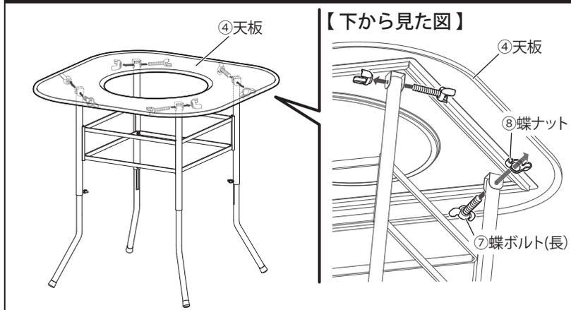
図のように④天板と②で組付けた脚をあわせ、⑦蝶ボルト(長)と⑧蝶ナットで組付けます。(4箇所)
