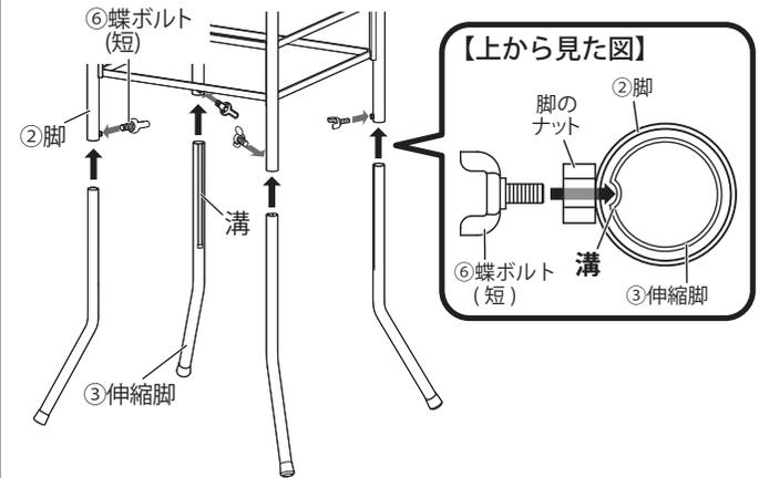
この時、③伸縮脚の溝に⑥蝶ボルト(短)が合うように固定してください。
