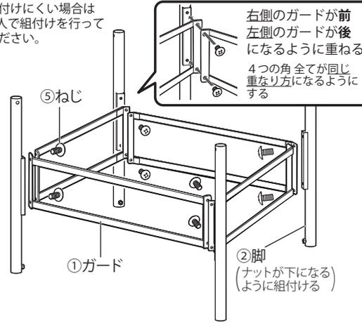
図のように①ガードと②脚を⑤ねじで内側から組付けます。(8箇所)
