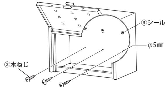
下部のネジ穴に残りの3本の②木ねじ で①本体 を固定してください。最後に 1 で仮止めした②木ねじ をしっかりと固定してください。取付けに使用しない穴は雨水の侵入防止の為、③シール でふさいでください。
