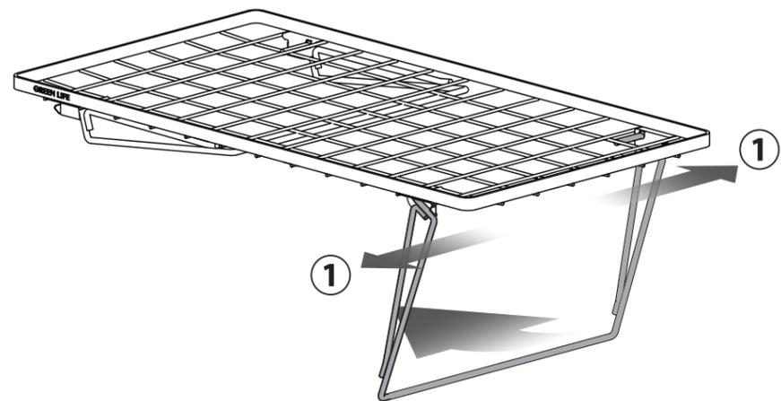
(1) 矢印①の方向に脚を広げ、突起部から脚を外して折りたたみます。
