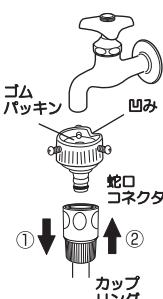
ゴムパッキンとねじで漏水・脱落を防ぎます
