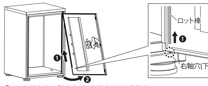
①ロット棒を上に引き上げ、右軸穴(下)から抜き
