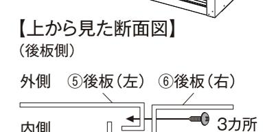
⑤後板（左）と⑥後板（右）を⑬薄板用タッピンねじで仮締めする（3箇所）
