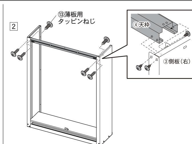
⑬薄板用タッピンねじで仮締めする。（6箇所）
