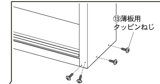
※②側板（左）も同様に①底板に⑬薄板用タッピンねじで仮締めする（4箇所）
