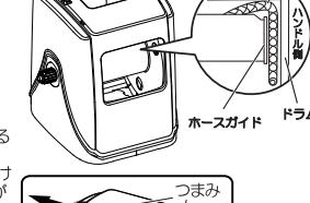
△ホースが片寄って巻かれる、カバー等に詰まる可能性があります。そのまま巻き続けると部品が破損する可能性があるので、巻取りが悪くなったら、ホースを一度引き出すか、カバーを外して詰りを解消して巻き取ってください。
