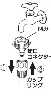
①(1) 蛇口コネクターについているカップリングを①の方向に下げて、部品を2つに分けてください。(蛇口コネクター、カップリング)
