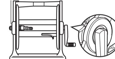
ハンドルを取付ける際は、反対側の蛇口側ホース取付部をしっかりと押さえて確実にたたき込んでください。
