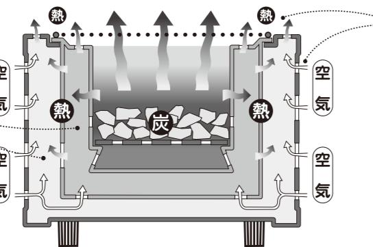
■本体に開いた多数の穴より空気を取り入れ、内部から伝わる熱を上部の開口部より外へ逃がす空冷断熱方式で、本体が熱くなりにくい設計です。
