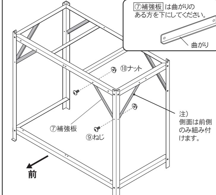
1. 本体を起こして⑦補強板を⑨ねじと⑩ナットで前側2本、後側2本、側面1本ずつ、計6本**仮止め**してください。
