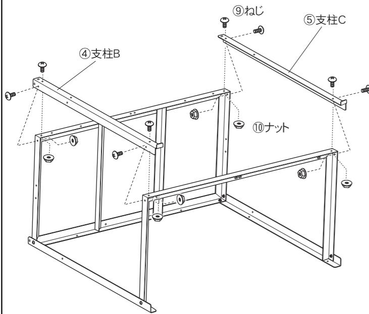
組み付けた②上枠③下枠の前側に④支柱B⑤支柱Cを⑨ねじと⑩ナットで**仮止め**してください。(上下左右8箇所)
