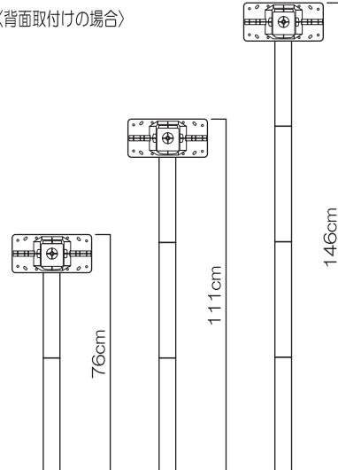
※使用時はポールを地面に埋め込むため、埋め込んだ分だけ高さは低くなります。
