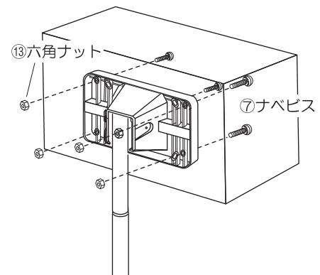
●ポスト背面の取付穴に⑦ナベビスを通し、⑬六角ナットで固定します。
