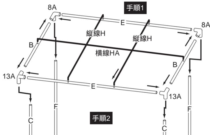
**手順1** パイプ[B]、パイプ[E]、サン[8A]、サン[13A]、縦線H、横線HAを上図のように組立ててください。
