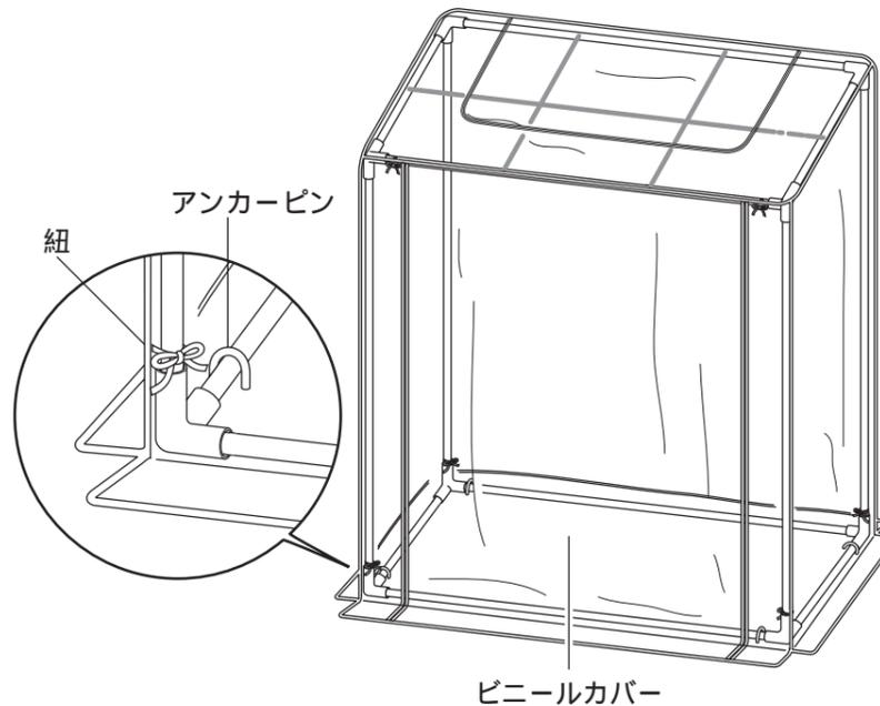
ビニールカバーを本体にかぶせ、パイプ[C]、パイプ[F]、パイプ[E]に紐を結び(計6箇所)、本体をアンカーピンで固定してください。(計4箇所)
