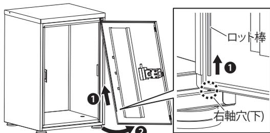
① ロット棒を上へ引き上げ、右軸穴(下)から抜き
