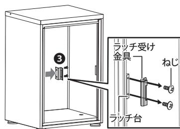
③ ラッチ受け金具を⊕ドライバーで取外します。
