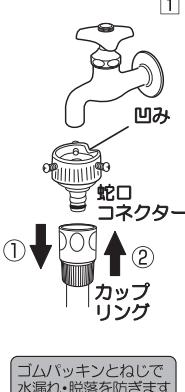
① (1) 蛇口コネクターについているカップリングを①↓の方向に下げて、部品を2つに分けてください。(蛇口コネクター、カップリング)
