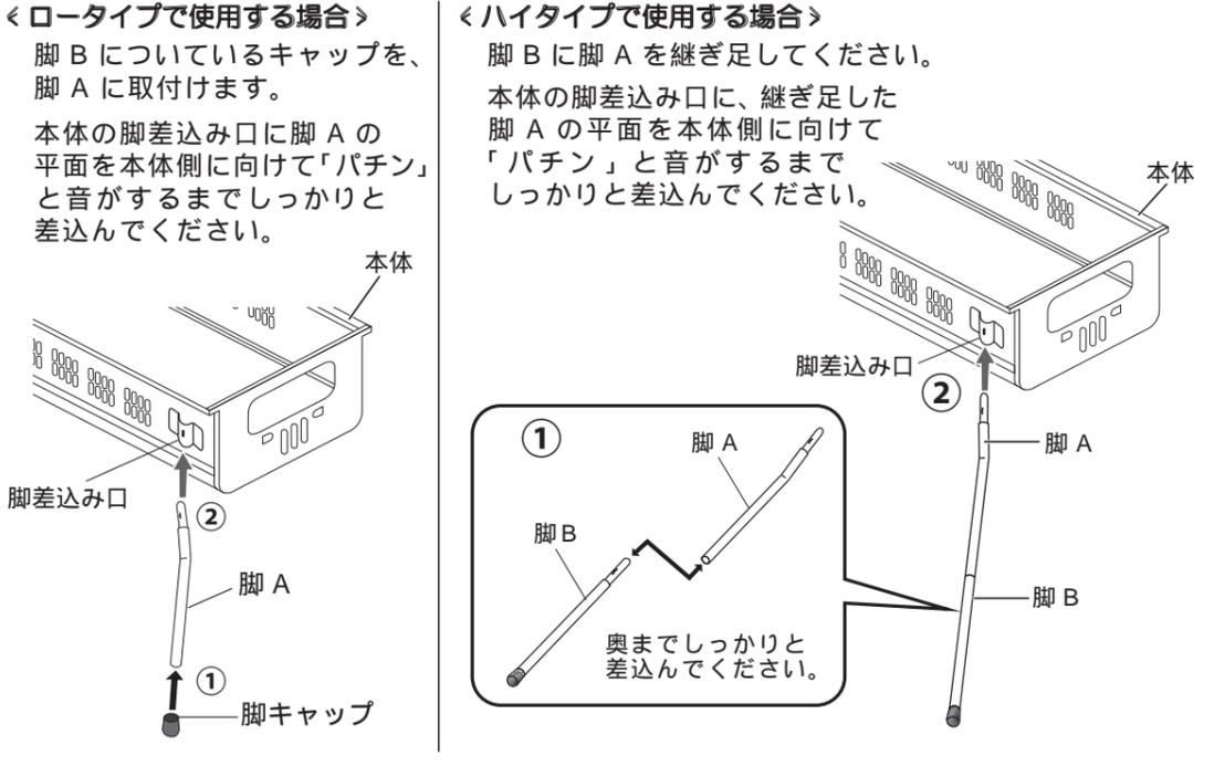
脚を本体から取外す際は、本体を押さえながら引き抜いてください。左右に軽くひねりながら引き抜くと取外ししやすいです。
