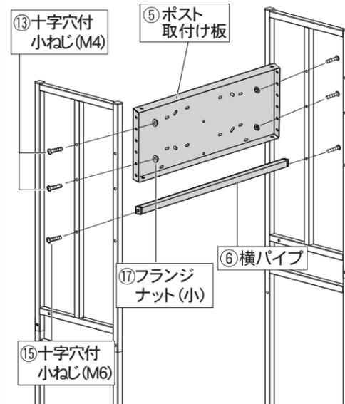
※⑤ポスト取付け板は、ポストの取付け高さを考慮し、ねじを通す穴を変えることにより、3段階に高さを調整することができます。
