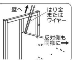
【設置方法】ポスト取付け板上部の穴(左右2箇所)にはり金を通して壁などに固定してください。はり金、ワイヤーは最寄りのホームセンターなどでお買い求めください
