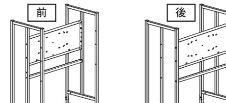
③で組付けた支柱に⑤ポスト取付け板を⑬十字穴付小ねじ(M4)と⑰フランジナット(小)で仮止め、⑥横パイプを⑮十字穴付小ねじ(M6)で仮止めしてください。
