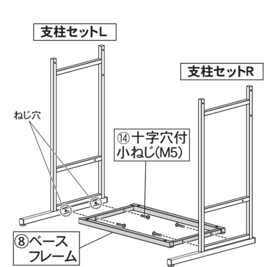
支柱セットLと支柱セットRのねじ穴が向かい合わせになるようにして、⑧ベースフレームを⑭十字穴付小ねじ(M5)で仮止めしてください。
