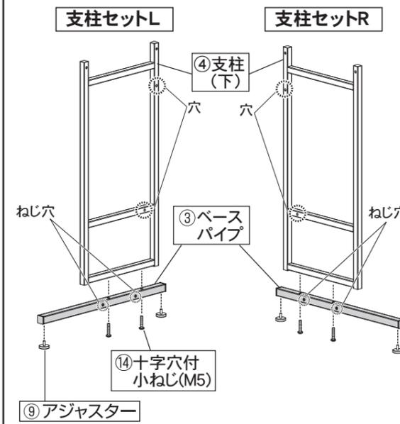
④支柱(下)に、③ベースパイプを⑭十字穴付小ねじ(M5)で仮止めしてください。③ベースパイプの下部に⑨アジャスターを取付け、支柱セットL、支柱セットRを作ります。
