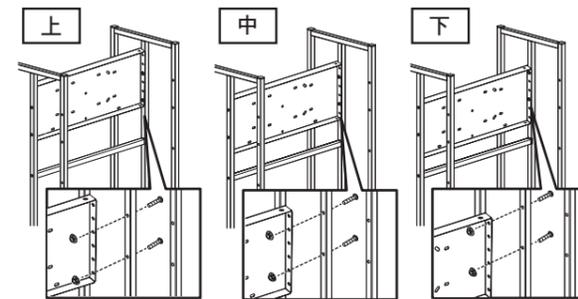
※⑤ポスト取付け板の位置を前後させることができます。ポストのサイズに合わせて取付け位置を調整してください。その際、⑥横パイプの取付け位置も併せて調整してください。
