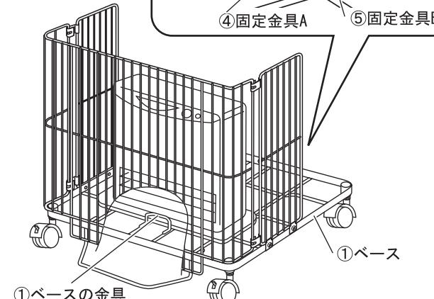
①ベースにガスファンヒーターをのせ、ガスファンヒーターの台を①
