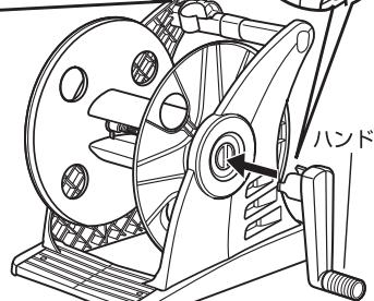
ハンドルを取付ける際は、反対側の蛇口側ホース取付部をしっかりと押さえて確実にたたき込んでください。
